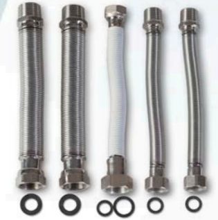
CONJUNTO PARA INSTALACIÓN DE CALDERA CON CONEXIÓN A GAS Kit de montaje fácil y rápido de calderas murales sin herramientas. COMPUESTO POR: - 2 Tubos extensibles 1/2" M-H de 200-400mm. - 2 Tubos extensibles 3/4" M-H de 200-400cc - 1 Tubo extensible 3/4" H-H de 300-600mm. blanco para gas - Sus juntas de goma correspondientes
