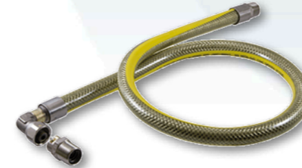
CONEXIÓN CON VÁLVULA DE SEGURIDAD PARA GAS Conexión roscada de 100cm. M-1/2" x H-1/2" para aparatos fijos y móviles a gas. Fabricado según norma UNE-EN 14800 y certificado por Aenor. Tubo corrugado de acero inoxidable AISI 316L recubierto de malla de acero inoxidable AISI 304 y protección exterior en pvc ignífugo. Con válvula de seguridad.
