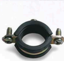
ABRAZADERA ISOFONICA PARA TUBO En acero bicromatado y caucho. Rosca para tornillo M-6. ISOPHONIC CLAMP FOR PIPE In dichromated steel and rubber. Thread for M-6 screw.
