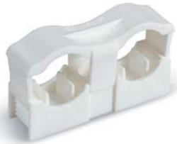
CLIP DOBLE PARA TUBOS DE 12 A 22mm Ø Permite fijar con la misma pieza tubos desde 12 hasta 22mm Ø. En poliamida blanca. Para tornillo M-6.
