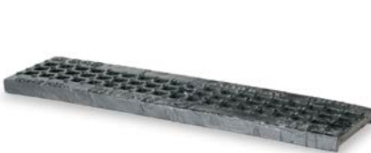
REJA PARA CANAL DE DRENAJE DE FUNDICIÓN DÚCTIL En acero de fundición dúctil. EN 1433 Clase C250 250 KN. DRAINAGE CHANNEL GRID IN DÚCTIL IRON In ductil iron. EN 1433 Type C250 250 KN.
