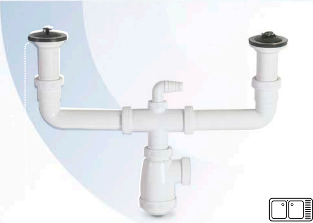
VÁLVULA Y SIFÓN DOBLE PARA FREGADERO DE 70 MM Ø Tipo extensible, con toma de lavadora. En polipropileno blanco y acero inoxidable. DOUBLE DRAINAGE VALVE AND TRAP FOR 70 MM Ø SINK Extending type with connection for washing machine. In white polypropylene and stainless steel.
