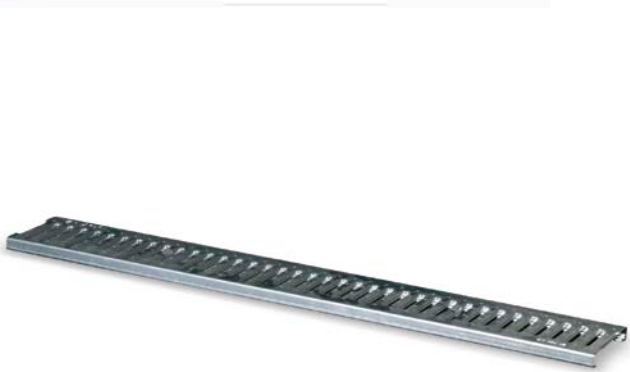
REJA PARA CANAL DE DRENAJE EN ACERO En acero galvanizado. EN 1433 Clase A15 15 KN.
