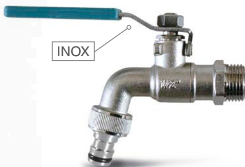
GRIFO DE ESFERA ANTIHIELO PARA MANGUERA En latón niquelado. Maneta inoxidable. Su sistema antihielo evita los daños a bajas temperaturas.
