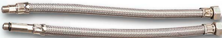
ENLACES PARA MONOMANDO DE 3/8"x10/100 En tubo flexible de alta presión, reforzado con malla de hilo de acero inoxidable. Racores de latón. MIXER TAP LINKS 3/8"x10/100 High pressure flexible tubing, reinforced with stainless steel mesh. Brass connections.
