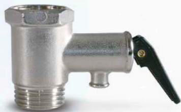
VÁLVULA DE SEGURIDAD PARA TERMOS CON PURGADOR En latón niquelado. Presión de tarado 8 bar.
