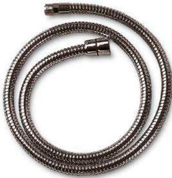
TUBO DUCHA EXTRAÍBLE FREGADERO De 125 cm. Tuerca cónica de 1/2" y tuerca macho 15/100. En latón cromado. PULL-OUT HAND SHOWER HOSE 125 cm. with 1/2" conical nut and 15/100 male nut. In chromium plated brass.
