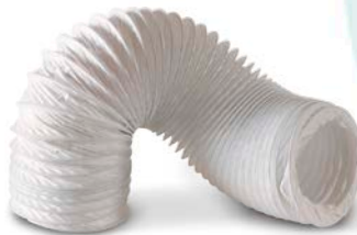
TUBO FLEXIBLE PARA VENTILACIÓN Y EXTRACCIÓN En PVC. Soporta hasta 80°C de temperatura de trabajo. Tiras de 10 cm. de largo estirable hasta 300 cm. FLEXIBLE HOSES FOR VENTILATION AND EXTRACTION In PVC. It supports 80°C of working temperature. 3 m. long.
