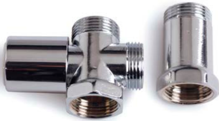
JUEGO DE ALARGADERA Y LLAVE DE PASO CON DERIVACIÓN En latón cromado. De 40 mm. de largo. Rosca 3/4". EXTENSION AND SHUT-OFF COCK WITH SHUNT KIT In chromium plated brass. Of 40 mm. long. 3/4" screw.
