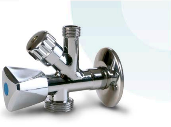
LLAVE ESCUADRA CON GRIFO DE LAVADORA Entrada de 1/2". Con 2 salidas independientes, una de 3/4" y otra de 3/8". En latón cromado. RIGHT-ANGLE SHUTOFF COCK WITH WASHING MACHINE TAP Inlet 1/2". With 2 separated outlets, one of 3/4" and the other one of 3/8". In chromium-plated brass.
